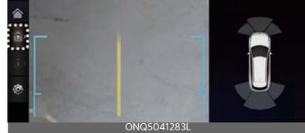
後頂視圖顯示停車時與車輛或車輛後部物體的距離。
