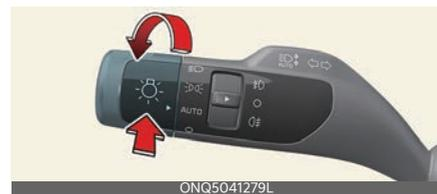
遠光燈輔助是一種依照偵測到的車輛亮度和路況自動調整大燈範圍（在遠光與近光之間切換）的功能。
