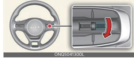
3. 設定的速限(1)將顯示在儀表板上。如果您想超過預設的速限，將油門踏板踩到壓力點以上以啟動強制降檔裝置。設定的速限將會閃爍，警告音會響起。在將車速恢復到速限以下時，閃爍和警告音停止。
