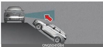
車輛在上坡、下坡坡道上或靠近坡道時，後方橫向碰撞警告可能會受到限制，且可能無法偵測到從盲點範圍駛近的車輛。如果發生這種情況，後方橫向碰撞警告系統可能不會在必要時警告駕駛。
