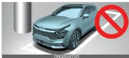
車位附近有狹窄物體、圓柱、方柱或被滅火器等物體包圍的柱子時，遙控智慧停車輔助性能可能會降低或與障礙物發生碰撞。駕駛應手動停車。
