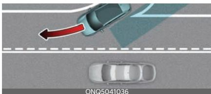
行駛於合併/分岔的道路時，盲點防撞輔助系統可能無法正常運作。盲點防撞輔助系統或未能偵測下一車道上的車輛。
