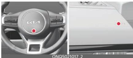
系統標誌為字母「AIR BAG」，凹刻在方向盤上的安全氣囊裝飾蓋及乘客前雜物箱上方的儀表板上。
