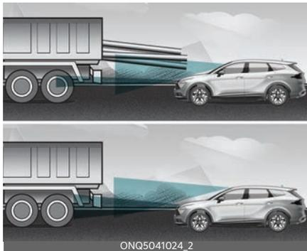
前方駕駛車輛室後方如有載運貨物時，或前方車輛的離地高度較高時，請務必格外謹慎駕駛。前方防撞輔助可能無法偵測到車輛後方的貨物。在此情況下，您必須與前車的最後緣維持安全煞車距離。必要時緊握方向盤踩下煞車踏板，降低駕駛速度，以維持適當距離。
