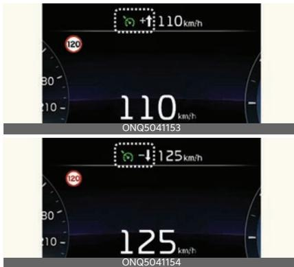
如果手動限速控制輔助或智慧定速巡航（如有配備）運作時道路的速度改變，會出現一個向上或向下的箭頭，告知駕駛必須變更設定的速度。此時，駕駛可根據速限使用方向盤上的 + 或 - 開關變更設定的速度。
