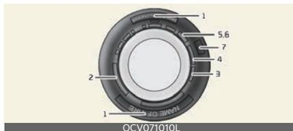
此資訊鑒定並描述輪胎的基本特性並提供用於安全標準證明的輪胎識別碼 (TIN)。在召回情況下，可以使用這個 TIN 識別輪胎。
