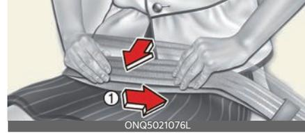
5. 在使用後排中央座椅安全帶時，必須使用帶「CENTER」標誌的扣環。
