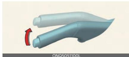
檢查停車煞車裝置的行程，數一數從釋放位置起拉響了幾聲「咔嗒」聲。另外，在陡坡上時，停車煞車裝置應單獨牢牢地穩住車輛。如果行程超出規定範圍，建議請Kia 授權經銷商檢查系統。
