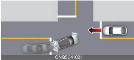
在十字路口左轉(左手駕駛)或右轉(右手駕駛)時，路口轉向功能可在打方向燈時進行緊急煞車，協助避免撞上相鄰對向車道上的來車。
