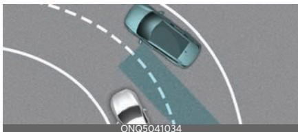
行駛於彎路時，盲區防撞輔助系統可能無法正常運作。盲點防撞輔助系統或未能偵測下一車道上的車輛。
