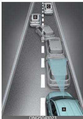
[A]: 您的車輛, [B]: 變換車道的車輛, [C]: 相同車道的車輛
