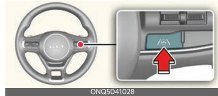
在車輛啟動的情況下，短按方向盤上的車道駕駛輔助按，以開啟車道跟隨輔助功能。儀表板上的灰色或綠色 (LFA) 指示燈將亮起。
