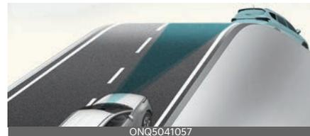
在上坡或下坡道路上行駛時，智慧巡航控制可能不會偵測到在您車道上行駛的車輛，導致車輛加速至設定速度。此外，如果突然識別到前方有車輛，車速將會急速減慢。
