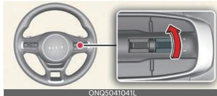
向上推 + 開關並立即釋放。每次以這種方式操作開關時，設定速度將以 1 km/h (1 mph) 間隔提高。
