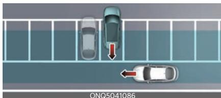
倒車入泊車位時，後方車輛防撞輔助功能可以偵測通過在後方駛過的車輛。如果發生這種情況，功能可能會在不必要的情況下警告駕駛並控制煞車。
