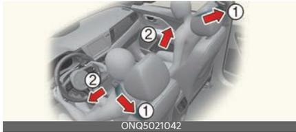
安全帶預緊器系統主要包含以下零件。
