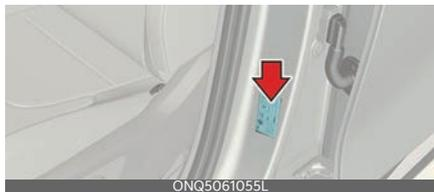
輪胎標籤位於如圖所示的中央立柱上，標有車輛的推薦輪胎壓力。選擇新車上提供的輪胎，以確保正常行駛的最佳效能。
