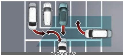
後方車輛防撞輔助系統可能會偵測到車輛附近正在停車或倒車的車輛 (例如從車旁駛離的車輛、後方停車或倒車中的
