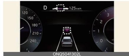
如果想在智慧巡航控制開啟的狀態下暫時加速，而不改變設定速度，可以踩油門踏板。踩着油門踏板時，設定的速度、距離等級和目標距離將在儀表板上閃爍。
