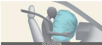
空氣囊組件位於方向盤的中央和雜物箱上方的助手席儀表板內。當 SRSCM 檢測到車輛前部的碰撞嚴重性達到一定程度時，會自動展開前安全氣囊。
