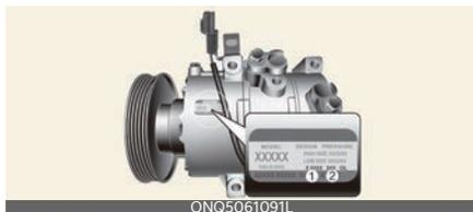
壓縮機標籤可告知您車輛配備的壓縮機類型，如型號、供應商零件號、生產編號、冷媒 (1) 和冷媒油 (2)。
