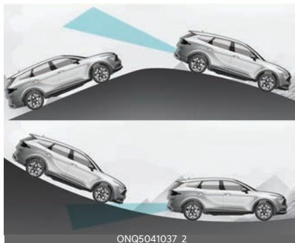
在彎路駕駛時，盲點防撞輔助系統可能無法正常運作。盲區防撞輔助功能可能無法偵測到下一車道的車輛，或者可能錯誤地偵測到地面或結構。
