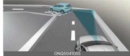
在彎路上，智慧巡航控制系統可能無法在同一車道上偵測到車輛，並可能加速至設定速度。此外，如果突然識別到前方有車輛，車速可能急速減慢。
