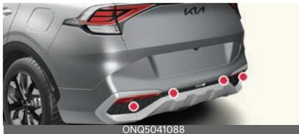
後超音波感測器位於後保險杆內，以偵測後方的物體。如果感測器上覆蓋有異物，例如積雪或雨水，可能會對感測器性能產生不利影響，並且後方停車防撞輔助可能無法正常運作。一定要保持後保險杆清潔。如果出現以下情況，警告訊息將出現在儀表板上：
