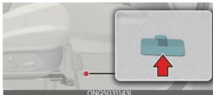
底板墊務必附接到固定件，以防止底板墊向前滑動。
