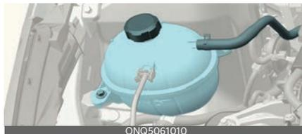
檢查所有冷卻系統軟管和加熱器軟管的連接部位和狀態，若有膨脹或變質則更換。
