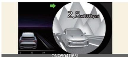
盲區影像監控在打方向燈時會在儀表中顯示車輛的後盲點，以協助安全地變換車道。
