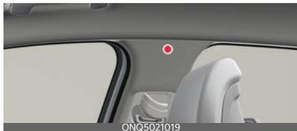
\* 車輛內的實際安全氣囊可能與圖示不同。窗簾式安全氣囊位於前後車門上方車頂縱梁的兩側。
