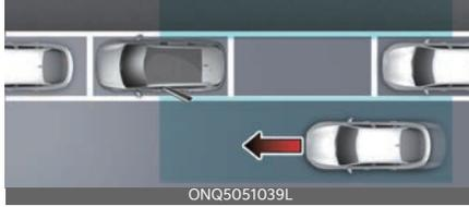
車輛停車後，當乘客打開車門，一旦發現後方有車輛駛近，安全離座警告將向駕駛發出警告訊息和警告音，以防止碰撞。
