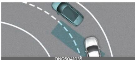
行駛於彎路時，盲區防撞輔助系統可能無法正常運作。盲點防撞輔助系統可偵測同一車道上的車輛。
