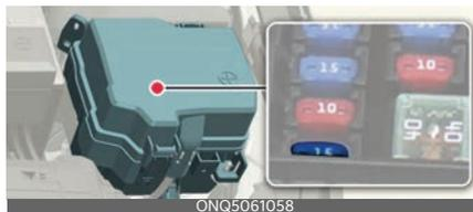
斷開葉片式保險絲時，利用發送機室保險絲盒中專為更換保險絲而設計的夾子將其拔開。斷開後，緊緊插入相同數量的備用保險絲。
