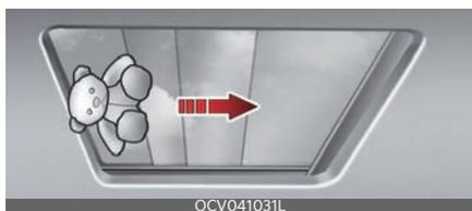
如果電動遮陽板或天窗玻璃感測到任何障礙物而天窗正在自動關閉時，天窗將反向並停在某個位置。
