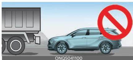
勿在公車、卡車等此類離地面間距較高的車輛旁使用遙控智慧停車輔助。這樣可能導致意外。
