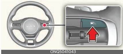
2. 到達希望的速度時按下駕駛輔助 ( ) 按鈕。設定的速度和巡航 ( ) CRUISE 指示燈將在儀表板上亮起。
