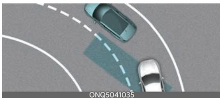
在彎曲道路上行駛時，盲點碰撞警示系統可能無法正常運作。盲點碰撞警示系統可能會偵測到同一車道上的車輛。務必在駕駛時注意道路與行車狀況。
