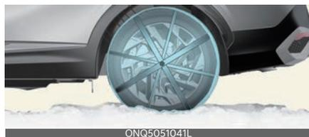
由於子午線輪胎側圍較薄，如果在其上裝配某些類型的防滑鏈，可能會損壞輪胎。因此，使用推薦的防滑輪胎代替雪地防滑鏈。不要在配備鋁制車輪的車輛上安裝輪胎防滑鏈，因為雪地防滑鏈會損壞這種車輪。如果必須安裝雪地防滑鏈，請使用厚度不超過 12 mm (0.47 in) 的織布型或鋼絲型防滑鏈。
