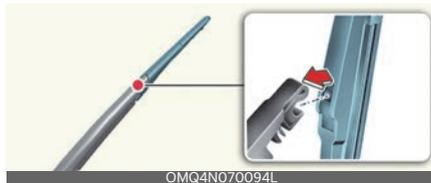
如果更換完成，放下雨刷臂將其放置在後擋風玻璃上，然後將車輛點火開關轉到 ON 位置，操作雨刷以檢查雨刷片是否正確安裝。
