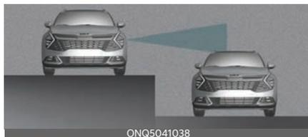
行駛於高度不同的車道時，盲區防撞輔助系統可能無法正常運作。如車道高度不同，盲區防撞輔助系統或未能偵測車道上的車輛。
